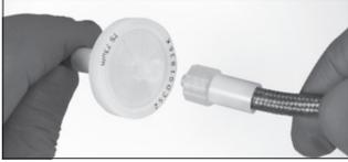
3. Entfernen Sie die alte Filterscheibe, indem Sie sie mit einer Hand festhalten und auf beiden Seiten durch Drehen von den Schlauchverbindern ablösen. Sie drehen sich in entgegengesetzte Richtungen.
