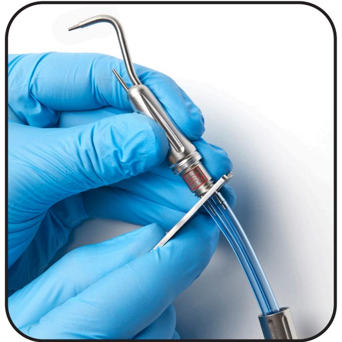
HINWEIS: Schieben Sie das Werkzeug von der schmalen Schlauchseite aus.
