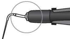
**Bitte beachten:** Die Spitze der Heizeinheit verfügt über 6 unterschiedliche Öffnungen zur Aufnahme des Stopfers. Föhren Sie den Stopfer in der von Ihnen bevorzugten Stellung ein, da die Heizung in Relation zur Stopferspitze schaltet.
