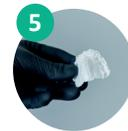
5 Das Material beginnt nach ca. **1 Minute** (je nach Menge des Granulates) **zu härten** und ist nach ca. **3 Minuten vollständig ausgehärtet**.
