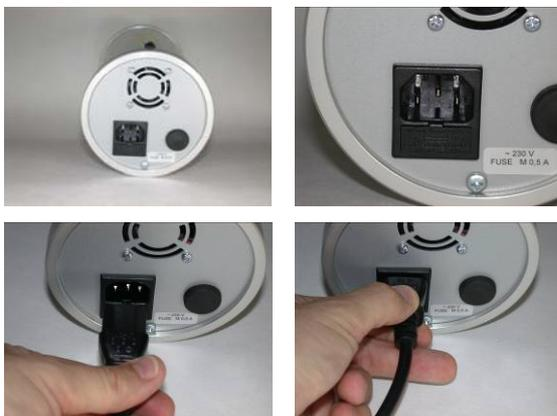
Verbinden Sie das mitgelieferte Netzkabel mit der Buchse auf der Rückseite und verbinden Sie es mit einer Steckdose.
