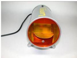
Schalten Sie das Gerät mit dem Kippschalter an der Geräteoberseite ein. Die Luftkühlung startet mit dem Ein- und endet mit dem Ausschalten des Gerätes.
